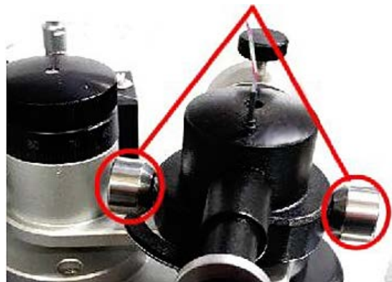
Боковые противовесы для точной настройки азимута
