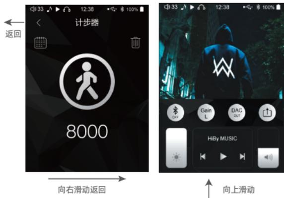
3、从屏幕底部向上滑动，可调出快捷功能，四个功能图标开启时显示金色，关闭时显示银色。并可调节屏幕亮度，音量大小、播放/暂停或切换歌曲等。
