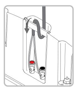
4.4 А теперь подсоедините колоночные кабели к пружинным разъемам на задней стороне тыловой коробки, сначала сделав петлю из кабеля на разгрузочной пластине, чтобы снять механические напряжения. Здесь вам потребуется помощник, чтобы держать тыловую коробку пока вы подсоединяете кабель. На рисунке выше проиллюстрировано подсоединение кабеля.
