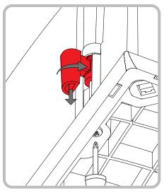
4.5 Подсоединенную тыловую коробку можно поднять и вставить в проем в потолке. На этом этапе необходимо обеспечить ее правильную ориентацию: красная стрелка на донышке коробки должна указывать на зону прослушивания.
