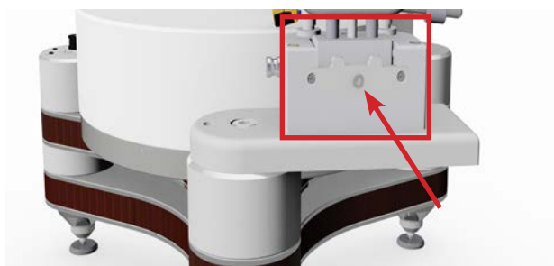
Abb. 13: Einstellung des Neigungswinkel
