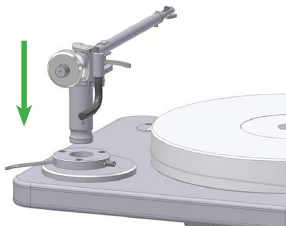
Abb. 5: Einsetzen des Tonarm
