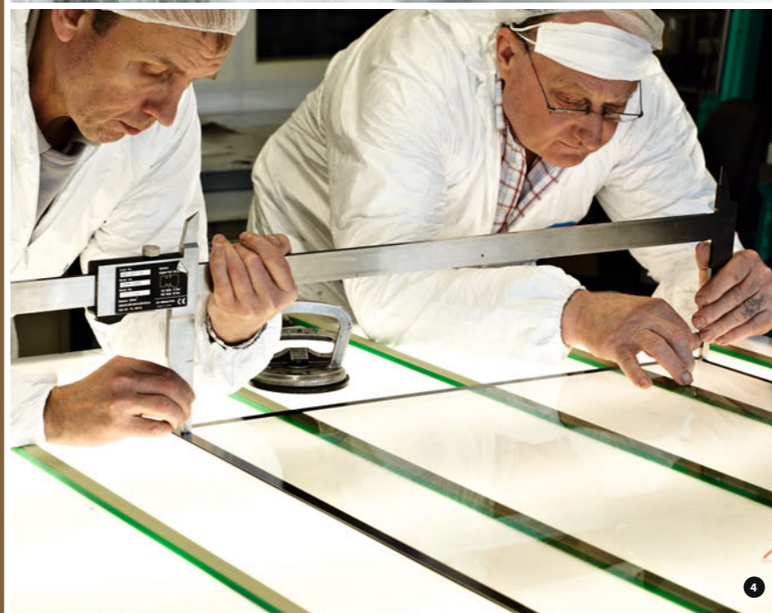
1 Уве Клингель рассказывает о функциях контрастного фильтра: «Серое тонирование усиливает контраст». 2 До 400 панелей контрастных фильтров может быть запечатано за смену. 3 Обработка алмазным резцом граней одного фильтра занимает до 10 минут. 4 Проверка после каждого этапа: печатные элементы должны наноситься с точностью до одной шестнадцатой доли миллиметра.
