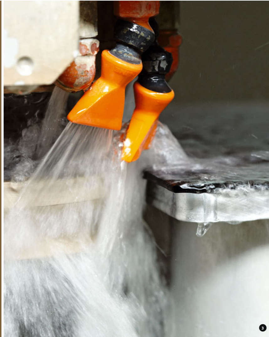
1 Уве Клингель рассказывает о функциях контрастного фильтра: «Серое тонирование усиливает контраст». 2 До 400 панелей контрастных фильтров может быть запечатано за смену. 3 Обработка алмазным резцом граней одного фильтра занимает до 10 минут. 4 Проверка после каждого этапа: печатные элементы должны наноситься с точностью до одной шестнадцатой доли миллиметра.
