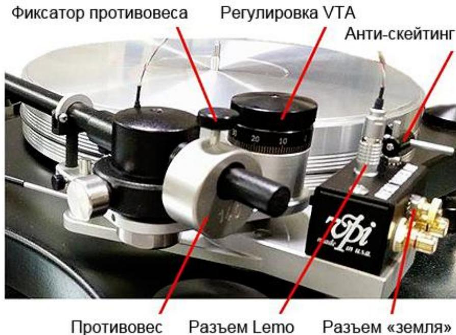
Прижимная сила регулируется путем перемещения противовеса тонарма вперед или назад на его валу. Если ваш картридж не балансируется и противовес максимально смещен назад или вперед, вы можете заказать у своего дилера подходящий противовес. Хорошо, если противовес находится посередине или в пределах средней трети своего вала.
