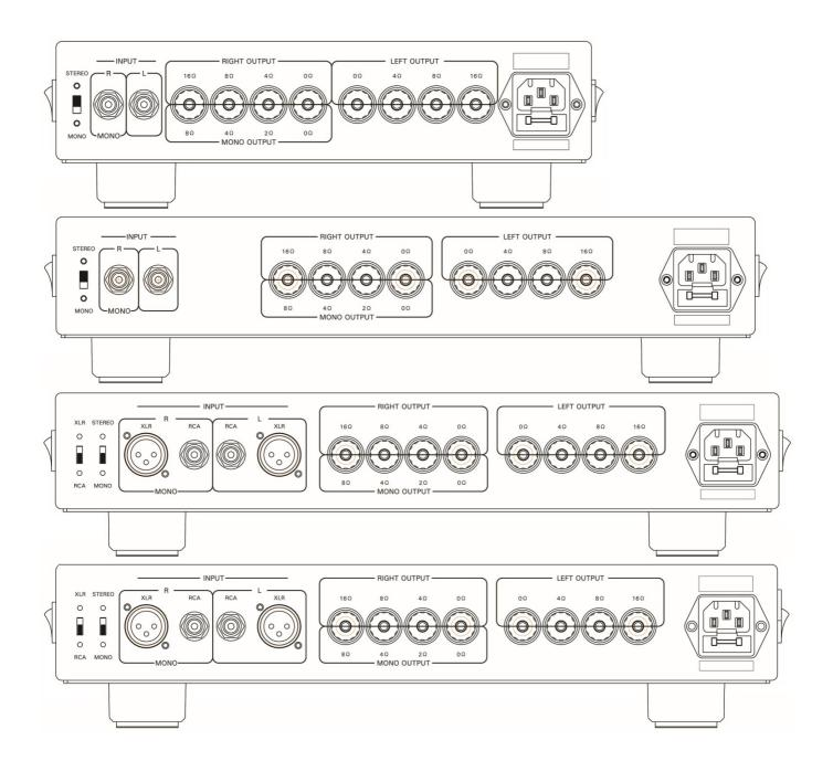
На задней панели устройства расположены входы и колоночные клеммы. Подключите контакт (+) ваших акустических систем к разъему 2, 4, 8 или 16 Ом, наиболее подходящему к среднему значению импеданса ваших акустических систем. Подключите минусовой контакт (-) колонок к разъему 0 Ом. Попробуйте подключить контакт к разъемам 2, 4, 8 или 16 Ом (+) для выбора импеданса, оптимально подходящего к характеристикам вашей акустической системы. Не подключайте наугад. Слушайте и доверяйте своим ушам.
