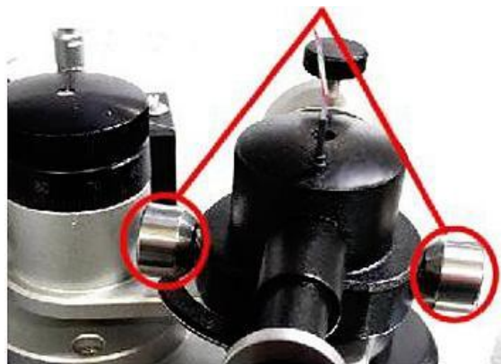
Боковые противовесы для точной настройки азимута
