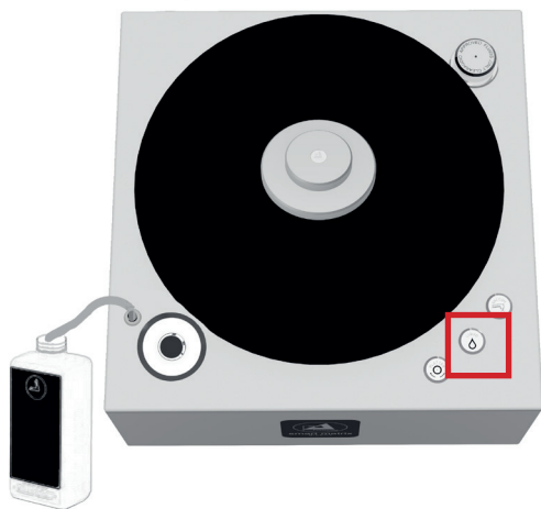
Abb. 11: Entleeren des Vorratsbehälters
