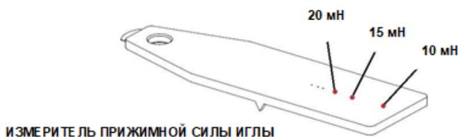
Для регулировки прижимной силы иглы осторожно перемещайте противовес (7) вдоль опорного стержня до тех пор, пока шкала измерителя не окажется в нейтральном ровном положении. Перемещение противовеса (7) в направлении от головки звукоснимателя уменьшает прижимную силу, а в направлении к головке звукоснимателя увеличивает ее. Зафиксируйте положение противовеса (7) при помощи шестигранного ключа из комплекта поставки.
