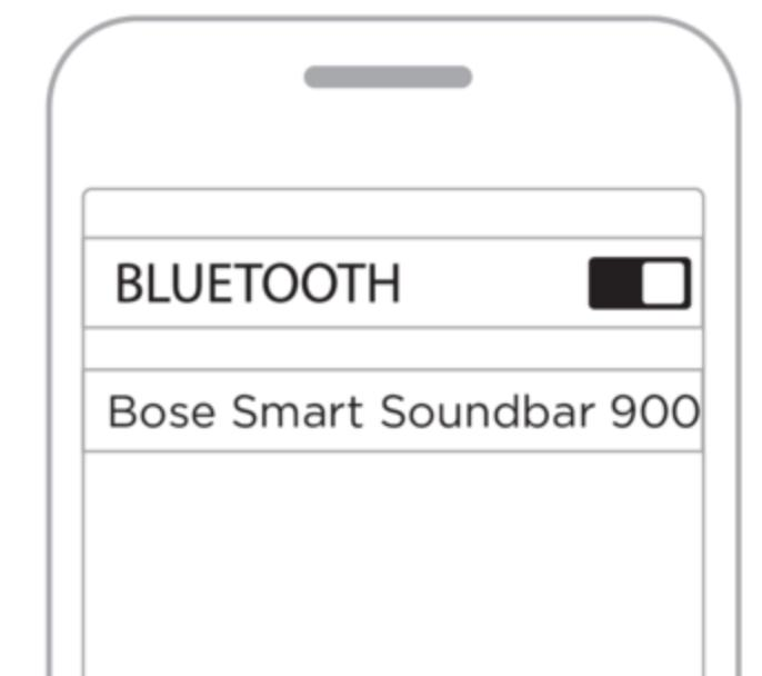
После подключения прозвучит звуковой сигнал, индикаторная полоса будет непрерывно гореть белым, а затем постепенно затухает до черного. Название саундбара будет отображено в списке мобильных устройств.
