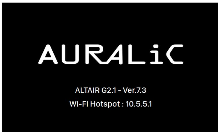
'Wi-Fi Hotspot' означает, что ALTAIR G2.1 передает сигнал Wi-Fi, используемый для настройки устройства в домашней сети. Убедитесь, что вы подключили сетевой кабель Ethernet к задней панели ALTAIR G2.1.
