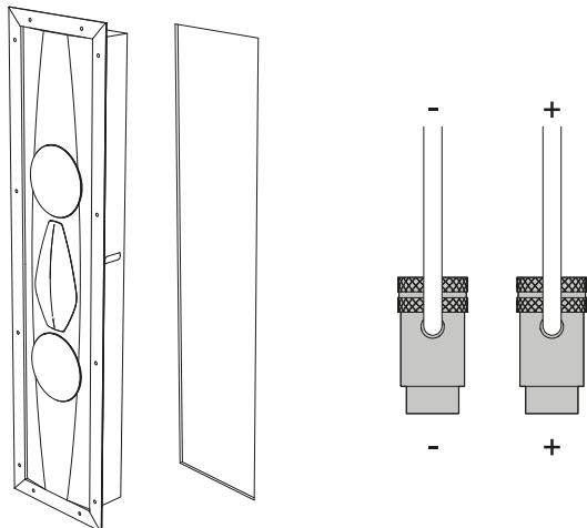
3.4.3 - ОТКРУТИТЕ РАМКУ, ВЫРОВНЯЙТЕ МЕТАЛЛИЧЕСКИЕ ЯЗЫЧКИ И СНИМИТЕ РАМКУ СО СТЕНЫ
