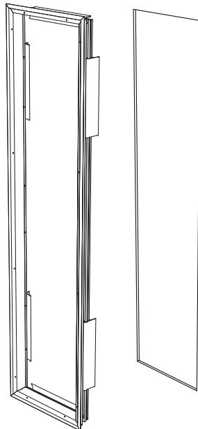
3.3.4 - ПРОТОЛКНите МЕТАЛЛИЧЕСКИЕ ЯЗЫЧКИ ДО СОПРИКОСНОВЕНИЯ С ВНУТРЕННЕЙ СТЕНОЙ
